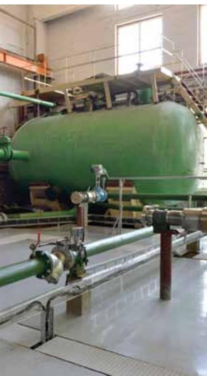
Испытательный стенд предназначен для определения виброшумовых, гидродинамических, расходных характеристик трубопроводной арматуры.
